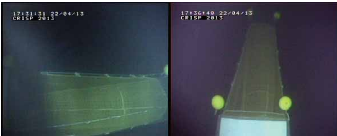
Figur 14. Bilder tatt av DeepVision fra Fokus. Nettseksjonen foran er laget i kvadratmasker.
