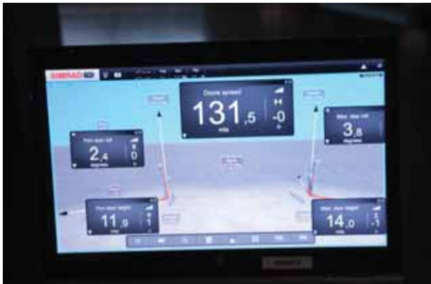
Figur 11. Skjermbilde med visning av plassering av tråldører over bunn og rollvinkel til disse, samt avstand mellom tråldørene.
