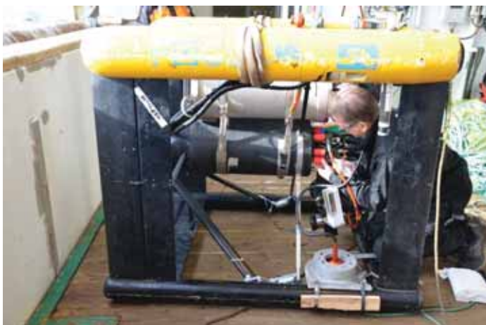
Figur 5. Fokus utstyrt med 120 kHz svinger og EK60 elektronikk i beholder (over hovedpod).
