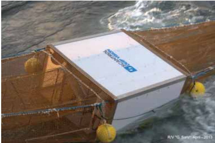
Figur 6. DeepVision enheten brukt i forsøkene.
