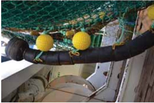
Figur 4. Kuler tredd inn på geartamper mellom gear og fiskeline.
