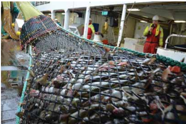
Figur 17. Fangst på ca 6000 kg låst bak fiskelåsen bakenfor fangstutslippet med matte på overpanelet.
