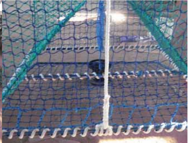
Figur. 6. Kvadratmasker nederst for utsortering av små krabber.
