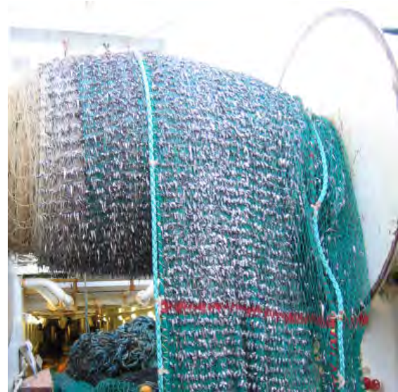
Figur 5. Eksempel på kledning av trålnot med lodde.
