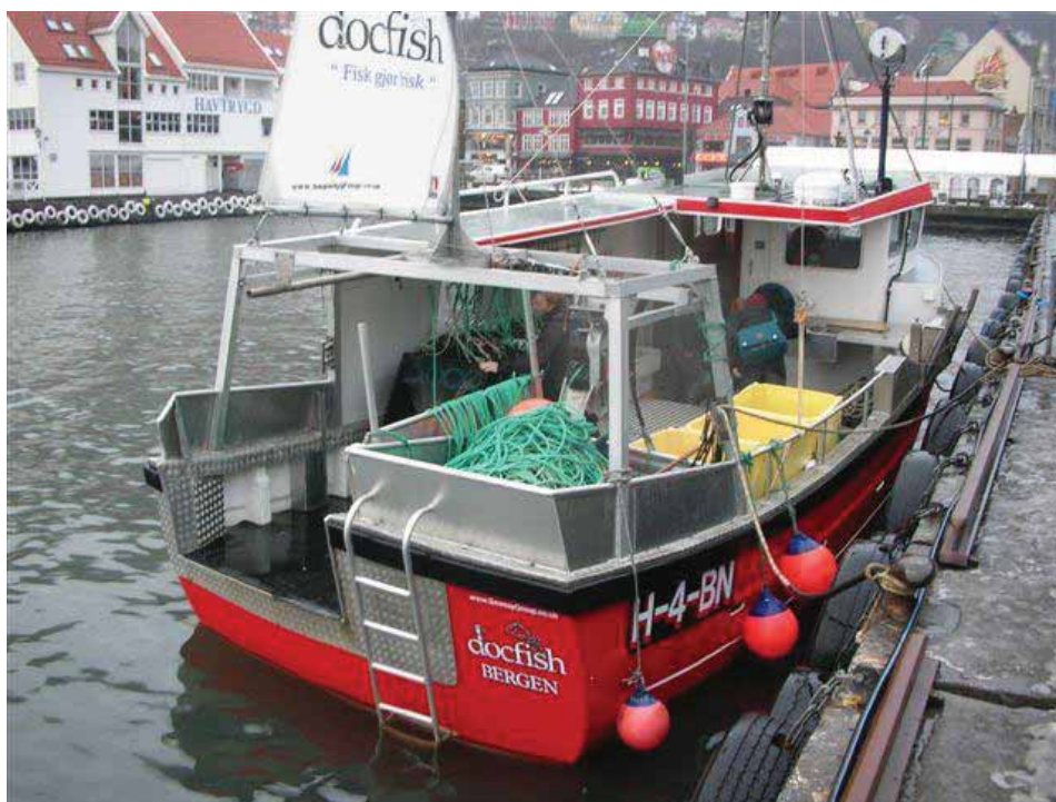
Figur 2. Teiner og teinerygg med utsettingåpning på "Docfish".
