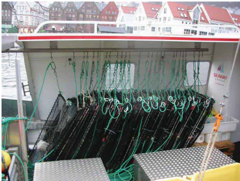
Figur 1. Hengende teinestabel på dekket til "Docfish".
