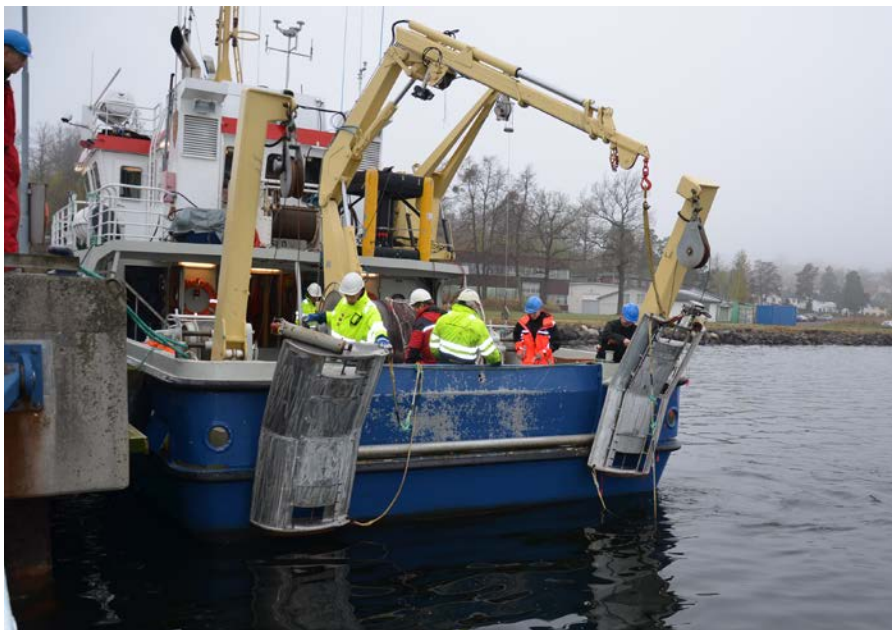
Figur 5. Tråldører med luker klar for testing om bord i "Trygve Braarud". Styrbord tråldør var utstyrt med motor for å regulere åpning av øverste luke under tauing.
