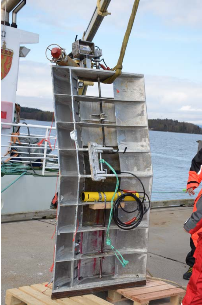
Figur 1. Styrbord tråldør med motor og kommunikasjonsenhet (cNODE) montert på toppen og med batteripakke (gul) midt i tråldøra.
