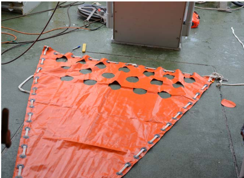
Figur 4. Løftekite på 1,5 \text{ m}^2 med 18 hull med 12 cm diameter.
