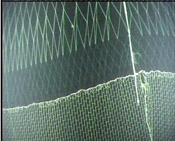
Figur 10. Sammenføring av mursteinsmasker og diamantmasker i 230 m trålen.
